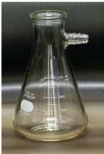
Utilizado na filtração a vácuo
