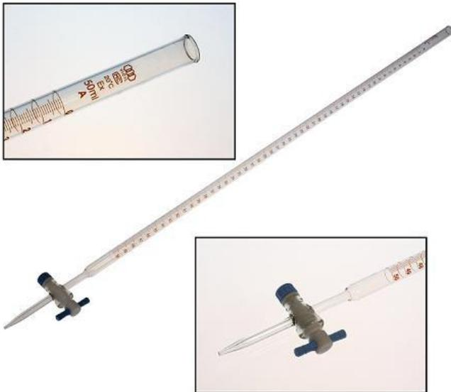
Material de precisão utilizado para adicionar, de forma regular, pequenos volumes da solução. Possui uma torneira que é utilizada para fazer essa regulação.
