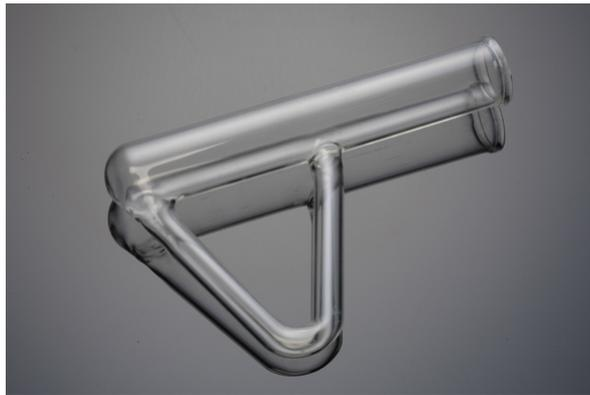
Auxilia na determinação do ponto de fusão e ebulição
