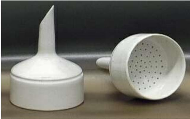
Utilizado na filtração à vácuo
